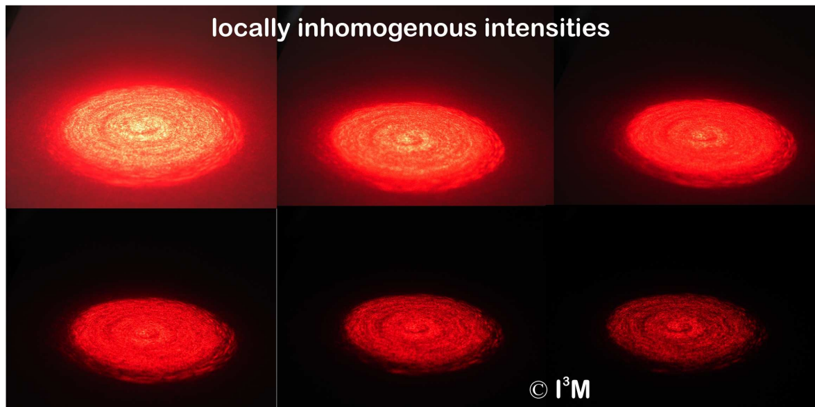
Bild 3: In einem Laserstrahl entstehen typischerweise lokal inhomogene Intensitäten.
